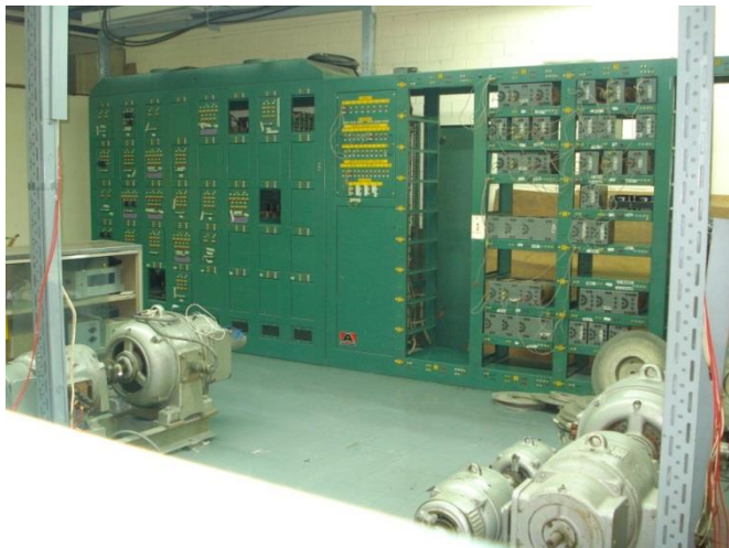
a) Micro red con máquinas síncronas de polos lisos y salientes de 4.5 kVA.
